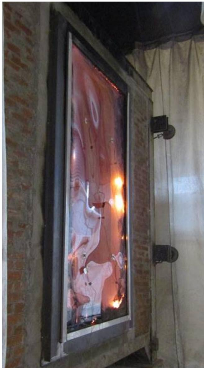
*Fig. 12 – Il vetro ripreso tra i 30 ed i 45' di esposizione al fuoco ( $T > 800^{\circ}\text{C}$ )*
